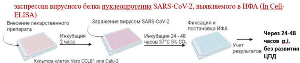
Рисунок 10 – Схема эксперимента по детекции экспрессии вирусного белка нуклеопротеина SARS-CoV-2, выявляемого в ИФА на культурах
